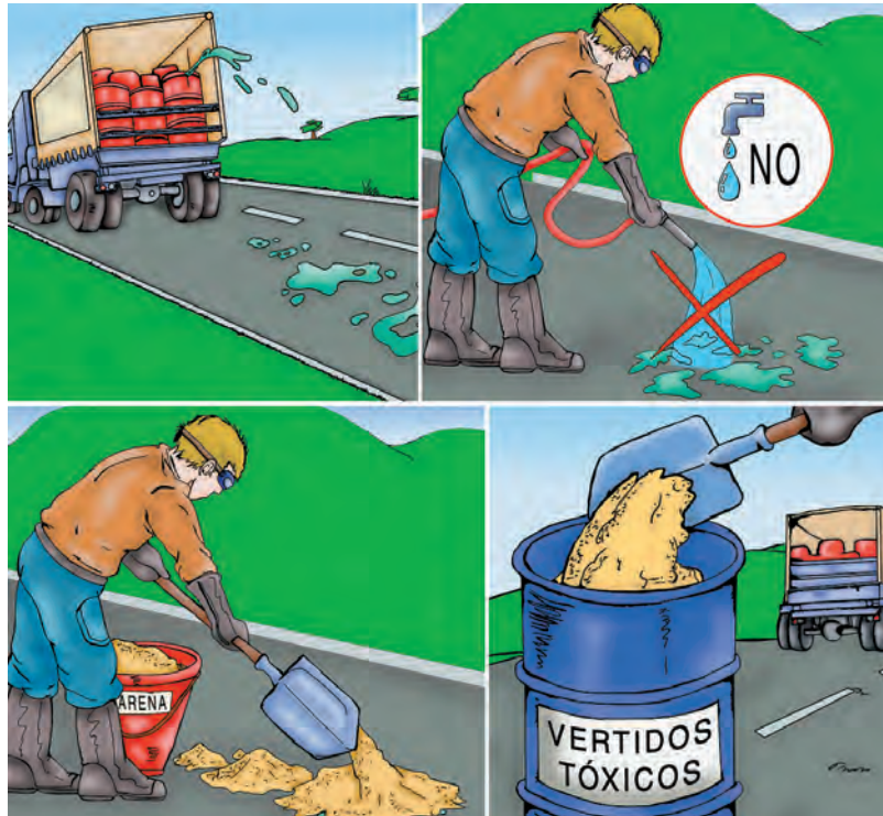
Figura 7. Los vertidos de un derrame serán eliminados de forma controlada
