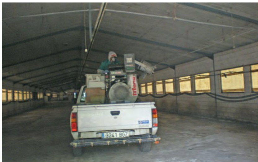
Figura 9. Sistema de pulverización móvil
