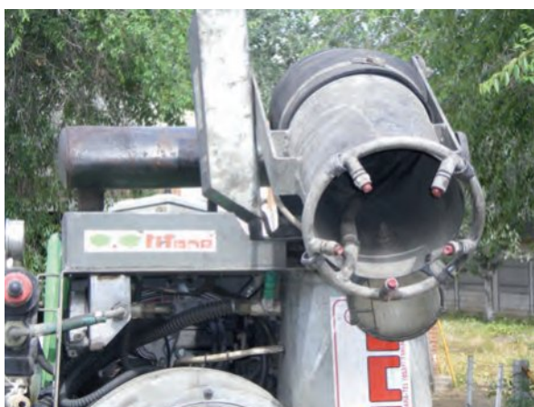
Figura 10. Las boquillas son un elemento importante en la revisión y calibración de la maquinaria de aplicación
